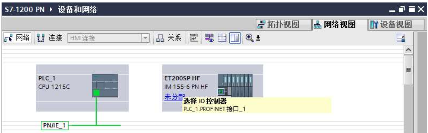
图8 IM155-6PN HF 分配IO控制器
